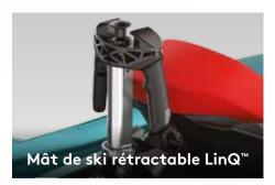
Ce mât de ski rétractable se monte rapidement et vous pouvez le ranger lorsque vous ne l'utilisez pas. Il est muni de montants de maintien pour la personne qui observe et d'une sangle pour attacher la corde lorsqu'elle n'est pas utilisée.
